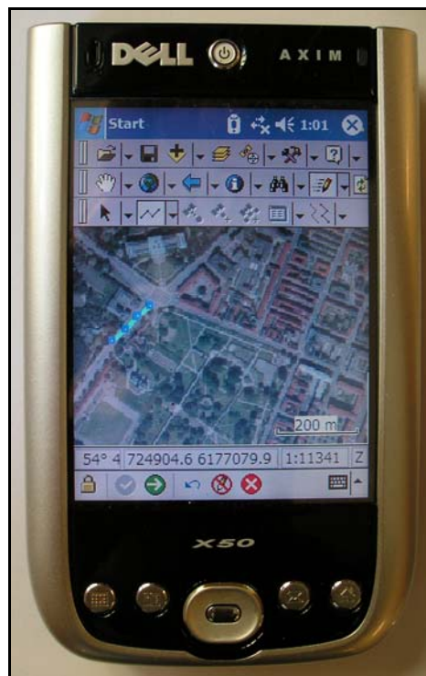
Figur 7. PDA hvor der er indlagt ArcPad med en indtegnet linje, der viser registreringen af de observerede R-segmenter.
